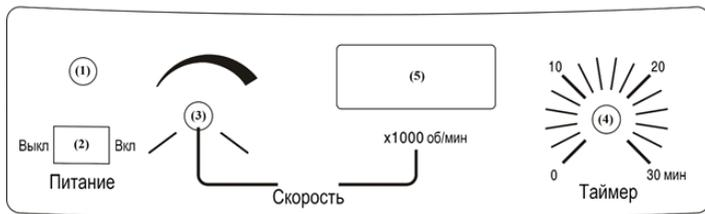
Рис. 2 – Схема элементов управления центрифуги LC-04B, где:
