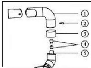
① рычаг светильника ② винт ③ декоративное покрытие ④ коннектор ⑤ соединительный вал
