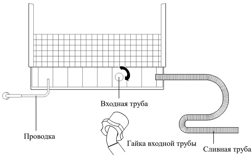
◆ Подключение отводящей трубы
