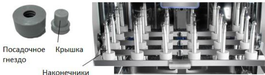
Наконечники вставляются в резиновые гнезда подноса. Пожалуйста, не помещайте их на дно, чтобы избежать попадания воды в наконечники. Возможно разместить 24 наконечника за раз. Когда машина работает, вы можете закрыть пустые отверстия резиновых гнезд крышками.
