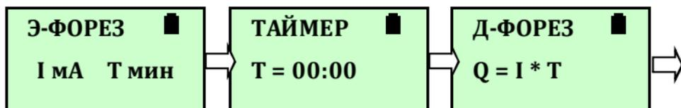
Для входа в отображаемый на экране режим (кроме режима **таймер**) нажимать на ручку **(2)** около 1 сек до смены индикации.
