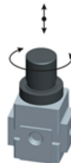
Abb. 15: Einstellung des Ausgangsdrucks
