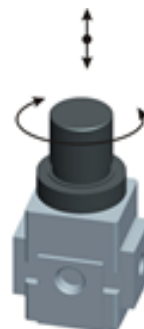
Obr. 15: Nastavenie výstupného tlaku
