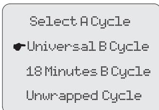
Нажмите на кнопку MENU/C, на дисплее отобразится меню циклов стерилизации (7 позиций).
