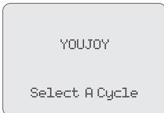
Включите аппарат в сеть. Нажмите на кнопку, которая находится в нижнем правом углу передней панели. Загорится индикатор кнопки, автоклав подключен к сети. Экран ничего не отображает, т.к. не работает, происходит автоматическое тестирование системы. После проверки системы автоклава на экране появятся надписи как на рисунке слева. Необходимо зайти в меню выбора цикла.
