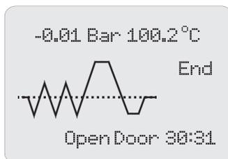
По завершении цикла стерилизации на дисплее отобразится надпись «End» и «Open Door», прозвучит звуковой сигнал. Откройте дверь, достаньте простерилизованные инструменты. По завершению цикла можно распечатать данные цикла стерилизации.
