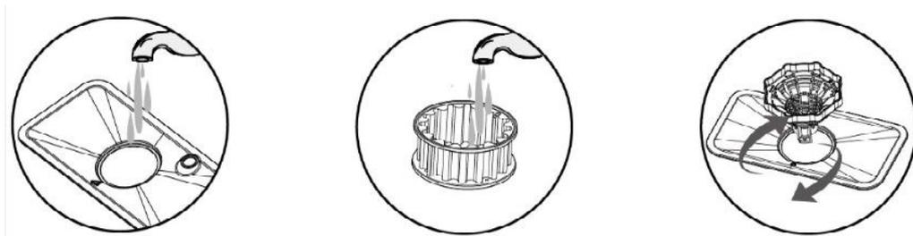
Промойте фильтр из нержавеющей стали проточной водой, можно использовать мягкую щетку. Не используйте железную, чтобы избежать повреждений.
